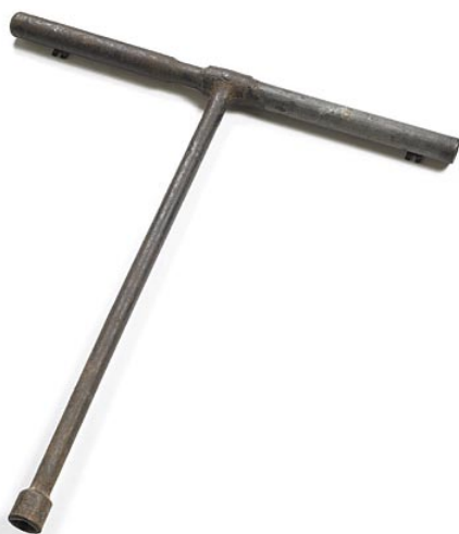
Clé à tire-fonds utilisée par les résistants pour déboulonner les rails © Musée de la résistance et de la déportation, Besançon
